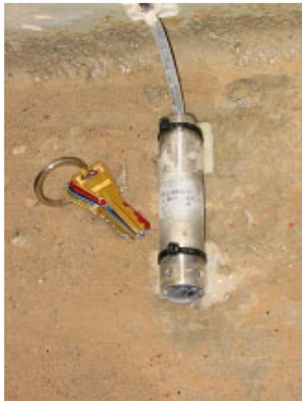
**Figure 28. Pressure sensor**
