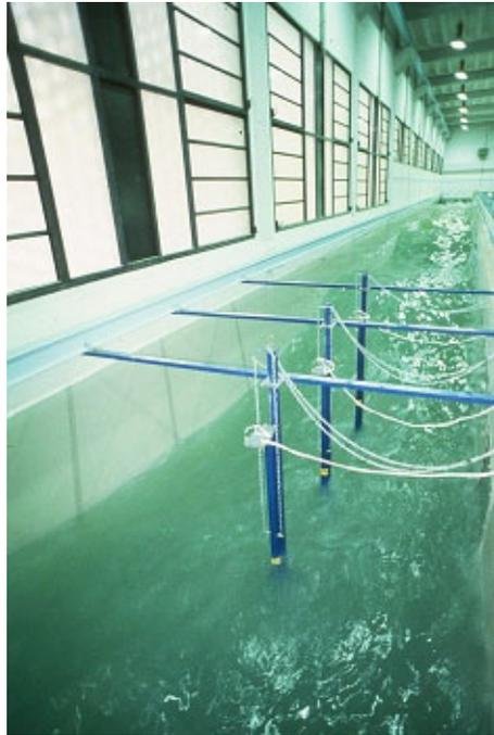
**Figure 27. Wave gauges.**
